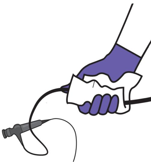
使用 Tristel Duo® 泡沫型消毒液对可能与探头接触的表面 (例如支架, 电缆和连接器) 进行高水平消毒。
